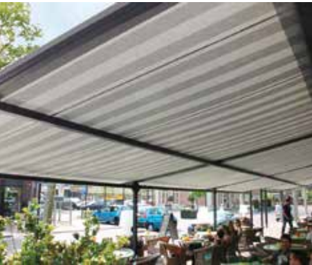
Mittige Leitrohre sorgen ab 350 cm Ausfall für geringeren Tuchdurchhang
